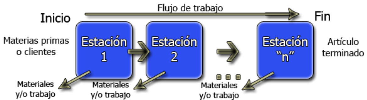
Ilustración 1: Flujo de producción o servicio en un Layout de Producto
